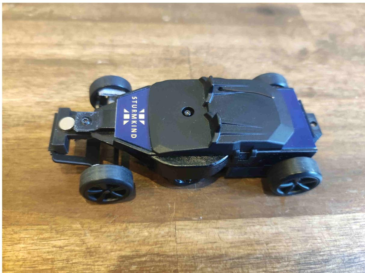
Einen mitgelieferten Magneten, wie oben im Bild zu sehen, aufkleben. Danach den 2. Magneten aufsetzen und mit Sekundenkleber im Chassis verkleben.
