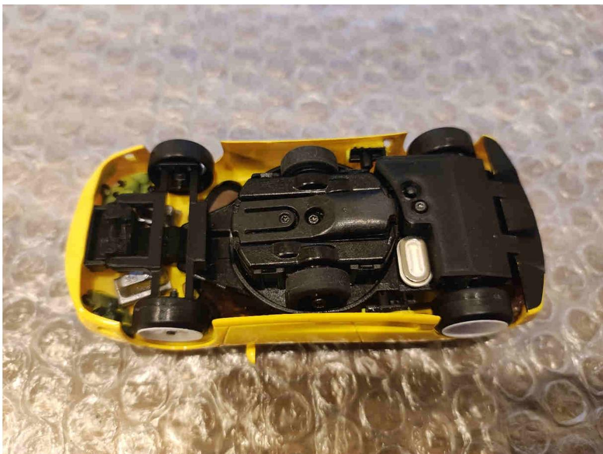
Die Antriebseinheit wird nur reingesteckt. Zuerst hinten und dann muss man die Karosserie etwas nach vorne biegen, bis der vordere Halter einrastet.
