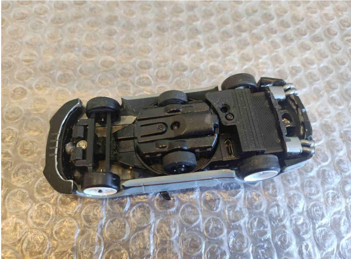
Da der Unterboden ebenfalls aus Metall ist, muss etwas mehr geschliffen oder gefräst werden. Ein guter Dremel ist hier notwendig.
