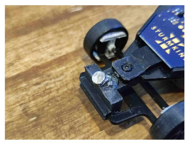
Das Einfügen der beiden Magnete ist am einfachsten, wenn zuerst ein Magnet, wie oben zu sehen, auf den Halter geklebt wird und das möglichst bündig zur Vorderkante.
